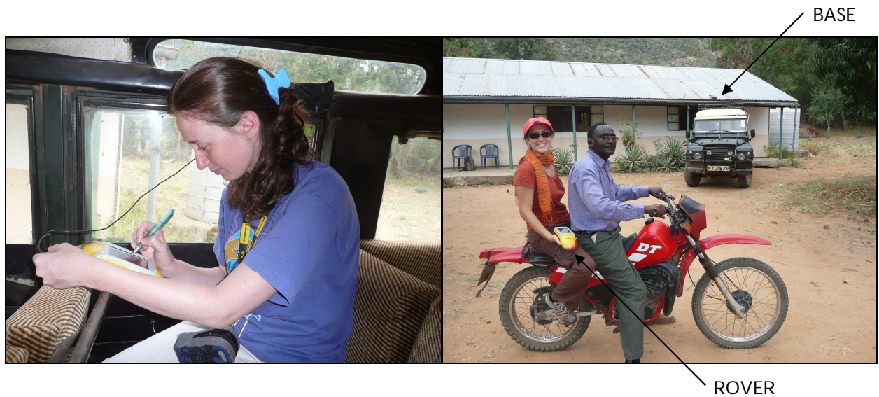
Figura 5.32: rilievo in movimento con ricevitore rover
